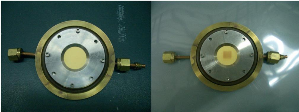
Abbildung 2.6: Das Bochum-Target vor (links) und nach (rechts) der Bestrahlung.
