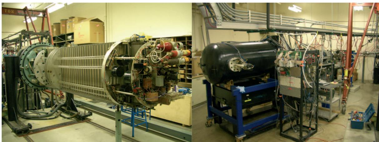
Abbildung 2.2: Beschleuniger KN (links, mit offenem Tank) und JN (rechts, mit geschlossenem Tank)
