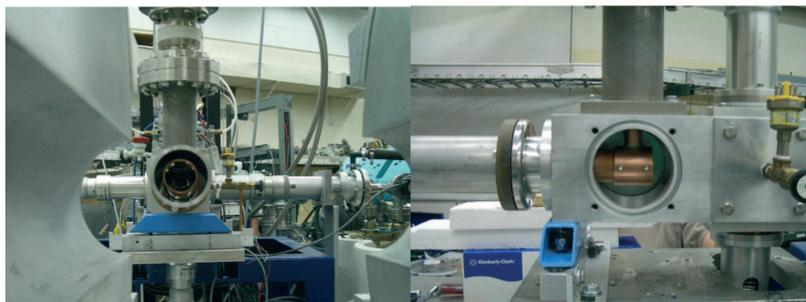
Abbildung 2.4: Schematische Skizze der Targetkammer und Bilder der geöffneten Kammer. Das Rohr innerhalb der Beamline und des abschliessenden Aluminiumrohres stellt die Kühlfalle dar, welche mit dem darüber montierten Kühlgefäß verbunden ist.
