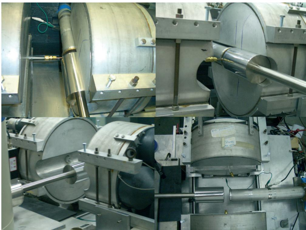
Abbildung 2.11: Der Aufbau I, dargestellt aus verschiedenen Perspektiven. Die NaI-Detektoren umschliessen zur Veranschaulichung den Ge-Detektor nicht.
